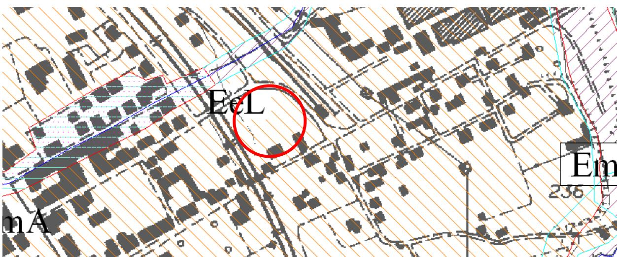
**Classe IIa:** moderato rischio per stratigrafia non omogenea e per la possibilità di ristagni e oscillazioni della falda libera con interferenza con strutture fondali e locali interrati.
