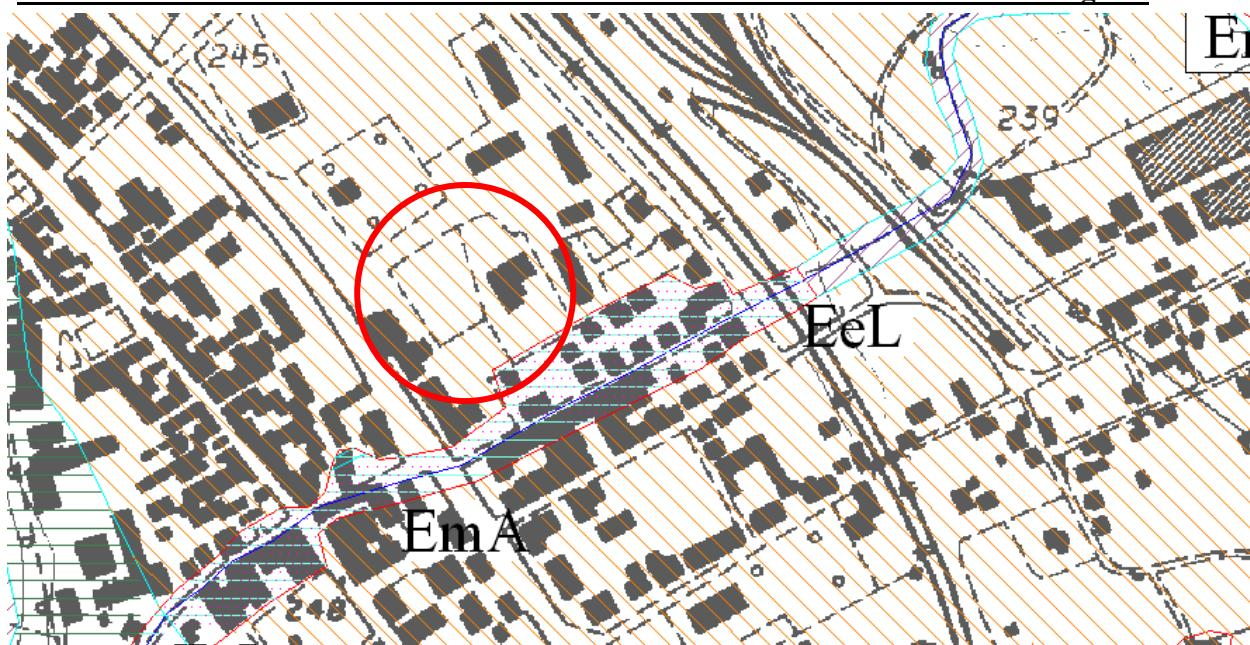
**Classe IIa:** moderato rischio per stratigrafia non omogenea e per la possibilità di ristagni e oscillazioni della falda libera con interferenza con strutture fondali e locali interrati.
