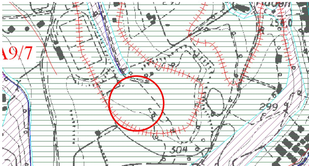
**Classe IIb**-moderato rischio per stratigrafia non omogenea, per la variabilità della potenza della copertura e dei parametri geotecnici dei terreni di fondazione, oltre alla moderata acclività.
