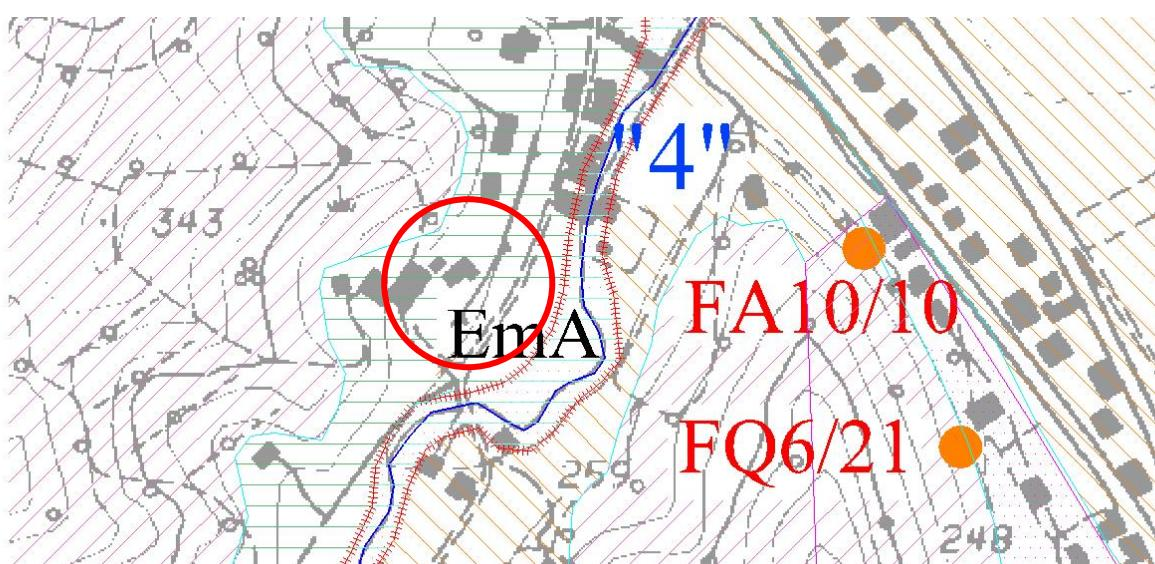
**Classe IIb**-moderato rischio per stratigrafia non omogenea, per la variabilità della potenza della copertura e dei parametri geotecnici dei terreni di fondazione, oltre alla moderata acclività.
