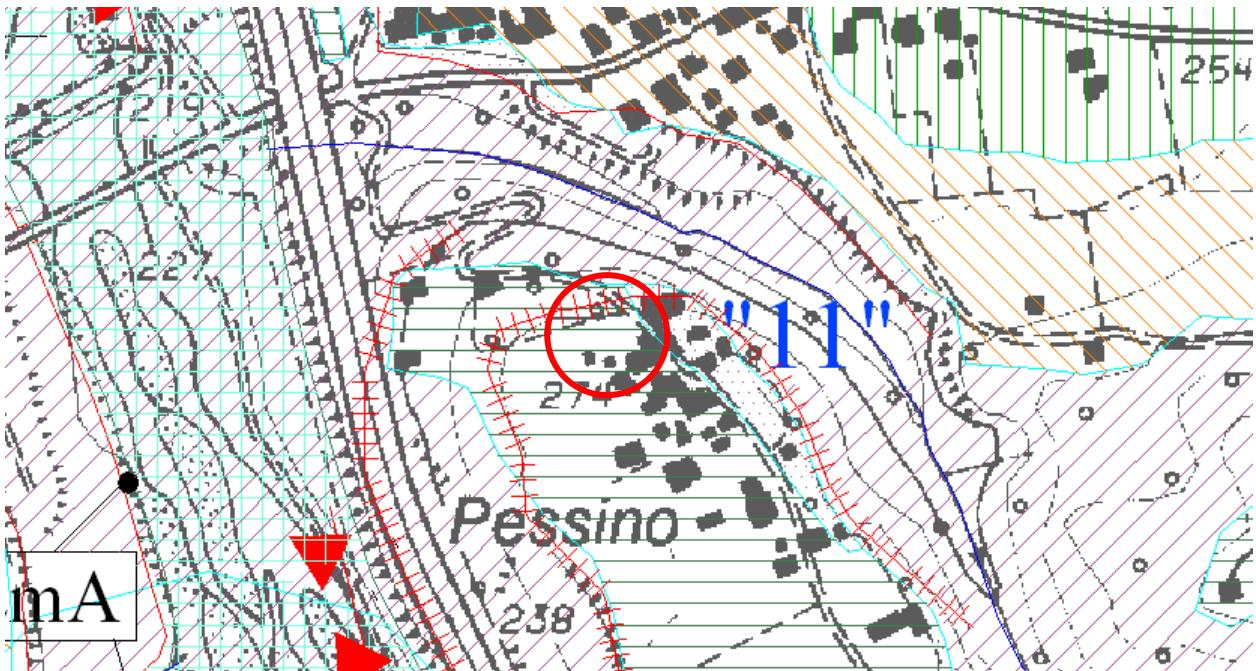
**Classe IIa:** moderato rischio per stratigrafia non omogenea e dalla presenza della scarpata di raccordo dei due ordini di terrazzamento fluviale.
