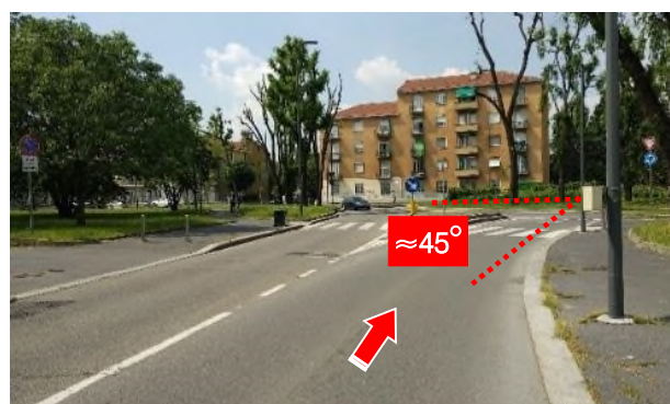
Figura 4.2 – Angolo di installazione dei radar rispetto alla direzione di marcia
