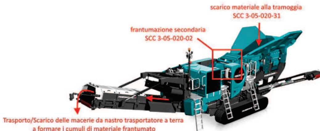
Figura 7 – descrizione delle attività concernenti la triturazione con frantoio.
